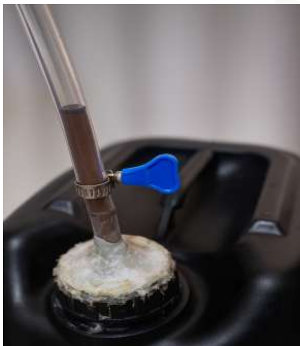
FIGURA 3. Bombona contendo a solução para fermentação anaeróbica.
