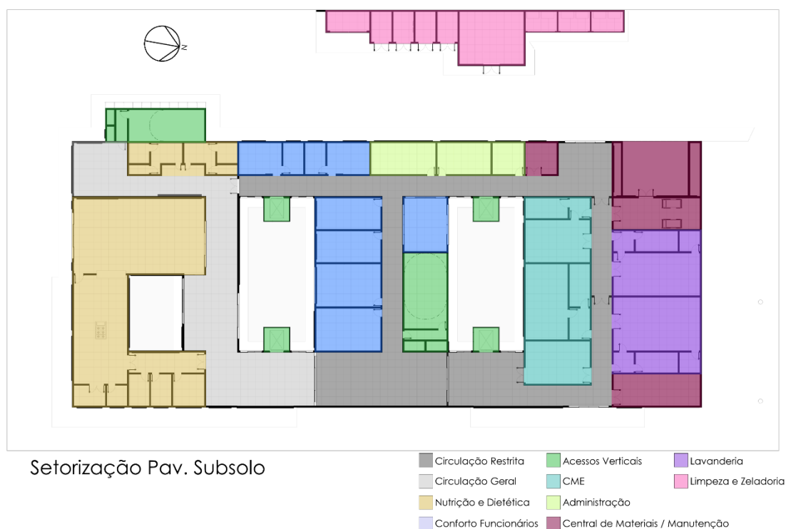
Figura 27 – Setorização do Pavimento Subsolo
