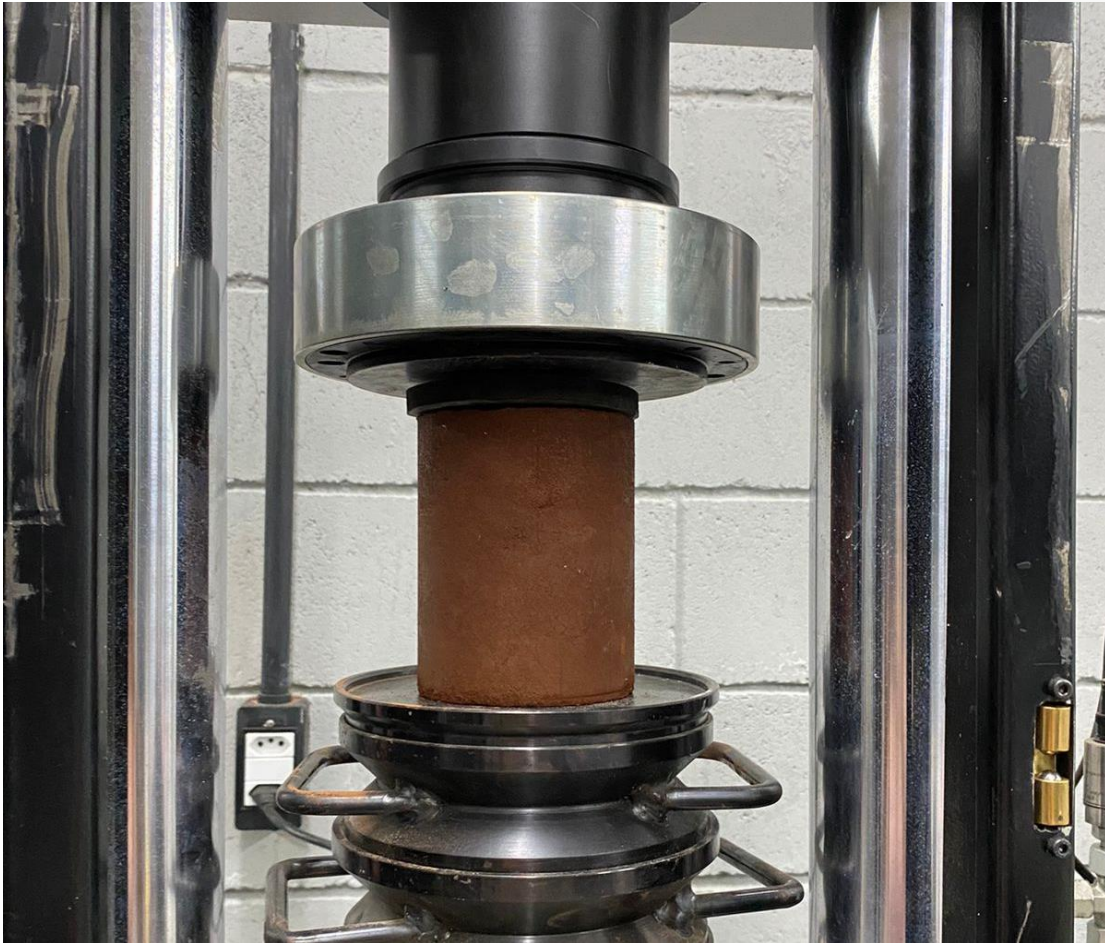
Figura 8 – Corpos de prova ensaio compressão.
