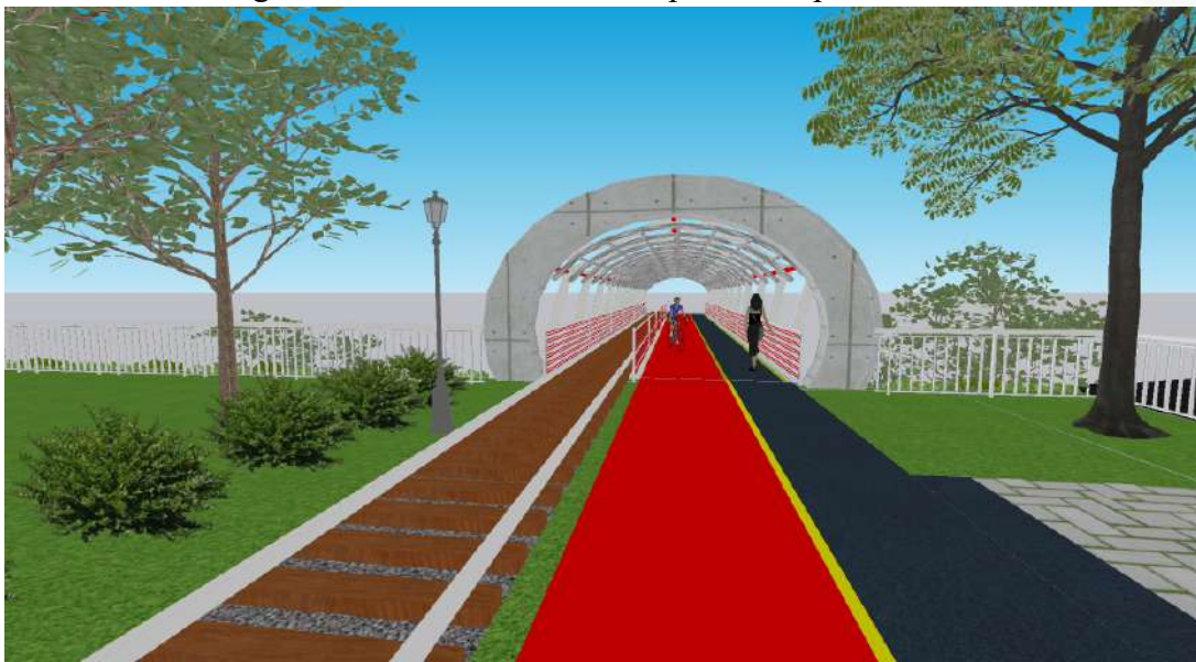
Figura 17– Passarela de acesso paralela a ponte férrea
