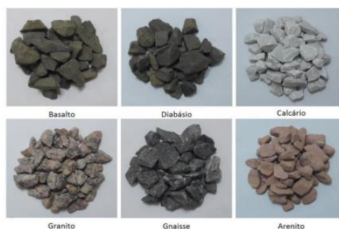
Figura 1 – Agregado graúdo Fonte: MATTIA,2017.
